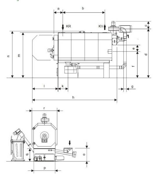
KR Kesselrücklauf KV Kesselvorlauf
